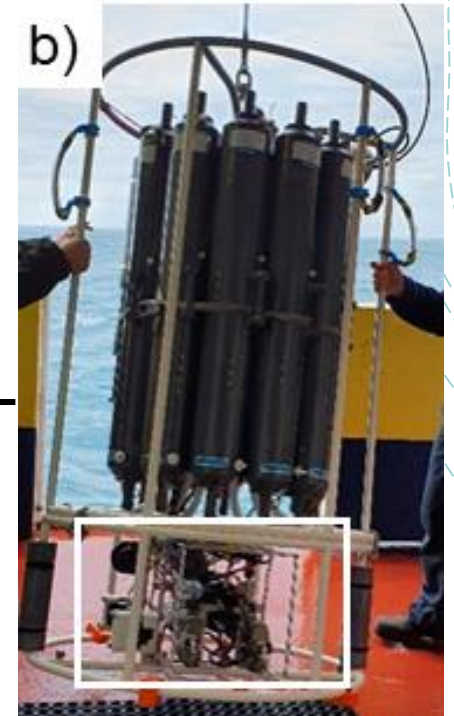
Bathysonde : LISST FLBBBCD Bouteilles Niskin (MES, Chl)
