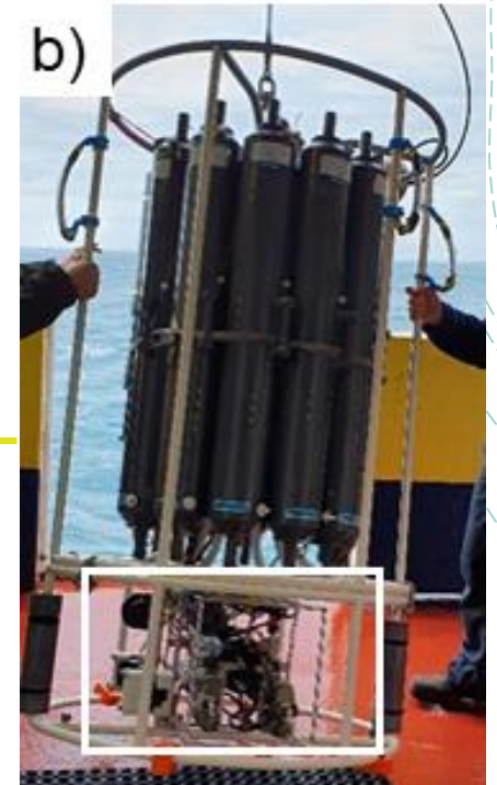
Bathysonde: LISST FLBBBCD Bouteilles Niskin (MES, Chl)
